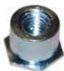
Le colonnine sono un fastener autoagganciante costruito per mantenere meccanicamente la distanza fra due superfici (es. scatola metallica - circuito stampato). La testa "annega" completamente nella lamiera permettendo ottime tenute a espulsione e trazione su lamiere sottili. Disponibili con filettatura cieca o passante.
