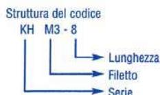
I prigionieri KH, KHS e KHA sono un fastener autoagganciante costruito per creare un filetto maschio solido in lamiera sottili. Il profilo del fastener è studiato per ottenere elevati valori di coppia e di espulsione. La testa del prigioniero affoga completamente nella lamiera e la parte filettata è disponibile perfettamente perpendicolare alla lamiera.
