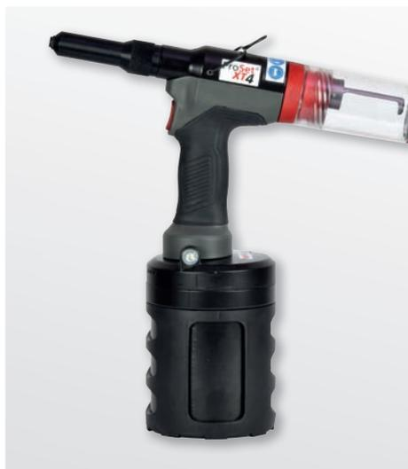
**76004-00001** - Il XT4 è l'utensile più potente della famiglia ProSet. Il XT4 fornisce con i suoi 23 kN la forza di trazione massima nella gamma, ma pesa solamente circa 2 kg. Oltre ai rivetti a strappo strutturali, la capacità del XT4 consente di installare i chivistelli Avdelok, Maxlok e Avtainer. La rivettatrice dispone di un pistone con trazione ultra elevata, che assicura la massima durata dell'utensile, e di un sistema di smorzamento idraulico per funzionamento uniforme.
