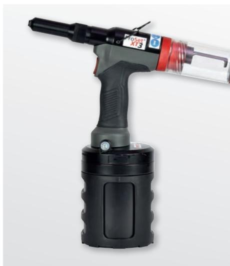
**76003-00001** - Il modello XT3 può essere impiegato in svariate applicazioni, impostando un'ampia gamma di dimensioni per rivetti a strappo, bulloni e tappi ermetici. La corsa elevatissima 26 mm consente il piazzamento di rivetti lunghi come Monobolt e Interlock in una sola impostazione.
